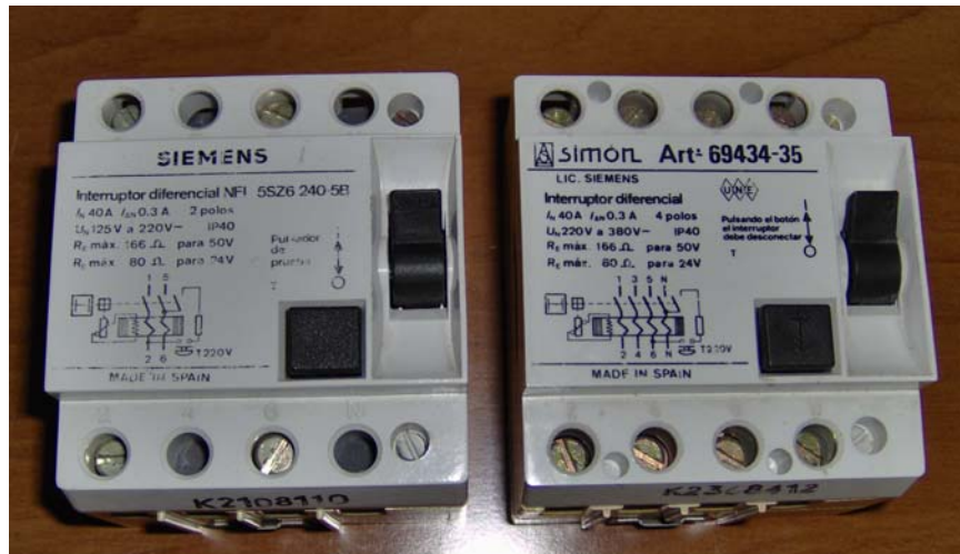
Figura 10. Interruptor diferencial monofásico y trifásico.
